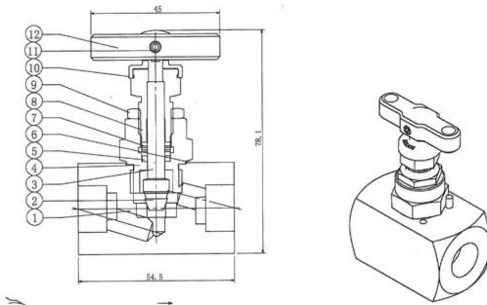
1. Ventilauslegung gemäß ASTM B1.6.34
